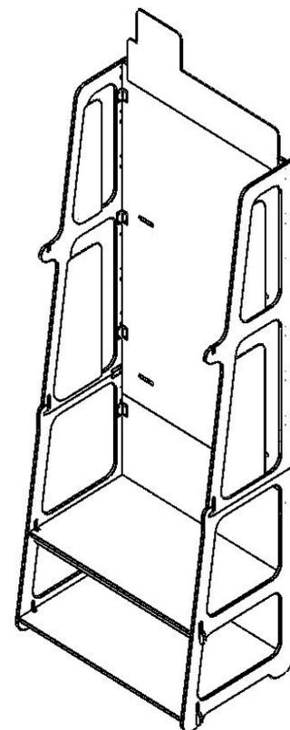
Positionner la partie supérieure du meuble (5) sur la partie inférieure (1), aligner et emboîter les côtés l'un sur l'autre à gauche et à droite.
